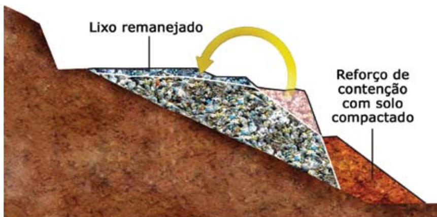
Figura 2 – Alternativa 1 para recuperação parcial de lixões
