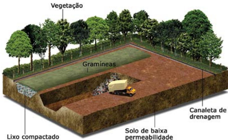
Figura 6 – Disposição final de Resíduos em Vala
