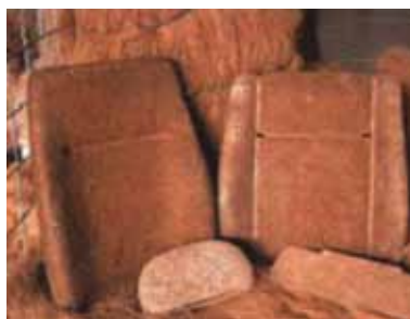
Foto 17: Fibras de coco utilizadas em estofamento de banco de veículos automotivos 3
