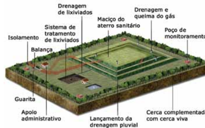
FIGURA 9: ESQUEMA DE UM ATERRO SANITÁRIO EM ÁREA
