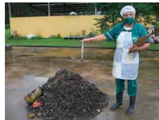
Foto 11: Medição de temperatura das leiras na UTC de Gonzaga - MG,
