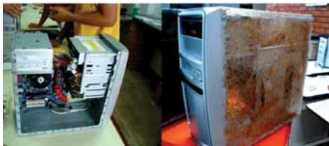
Foto 16: Gabinetes ecológicos desenvolvidos com fibra de coco verde 2
