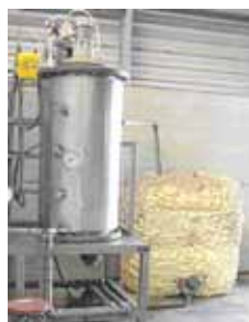
Foto 19: Unidade da Planta-Piloto de tratamento anaeróbico dos resíduos sólidos urbanos para geração de bio-hidrogênio 5
