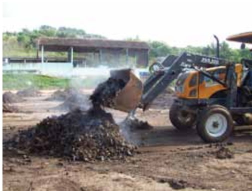
Foto 10: Reviramento mecânico das leiras na UTC de Ilícinea - MG
