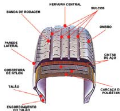
Figura 1 – Estrutura de um pneu radial
