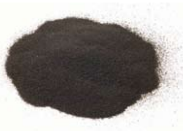
Figura 14 – Pó de borracha usado na mistura de asfalto borracha
