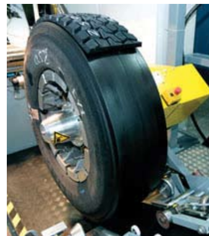
Figura 6 – Aplicação da nova camada de borracha em processo de recauchutagem
