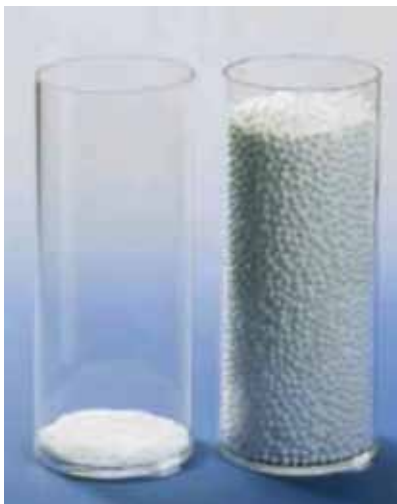
Foto 2: Antes e depois do material expandido
